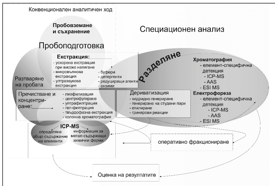
Фиг. 1. Схема на стандартен аналитичен ход при определяне на елементи в свързани форми в растителни проби.
