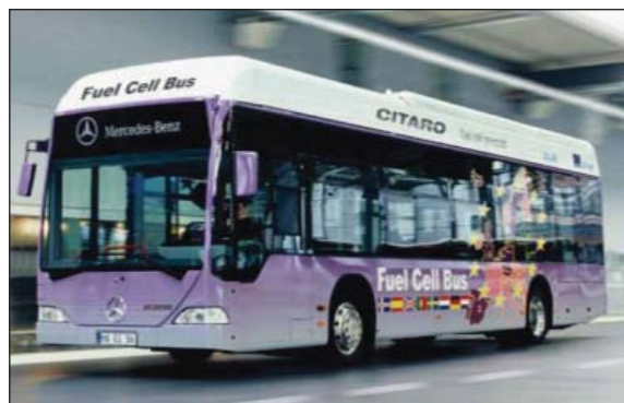
Фиг. 2. Електрически автобус, задвижван от горивни елементи.
