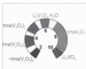
Фиг. 2. Влияние на рН върху фазообразуването за реакция между V 2 O 5 , ТМАОН, LiOH в съотношение 1:2:1 и температура 458 К.
